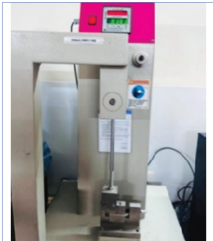
[Table/Fig-4]: Izod Impact testing machine.
